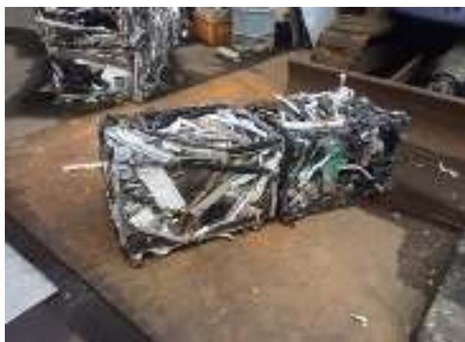
アルミ材のみは圧縮固体化
